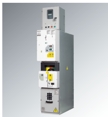
Celda de protección de transformador con seccionador SF6 e interruptor automático en vacío. Entrada de cables desde abajo, salida de cables por arriba, ancho 375mm.
